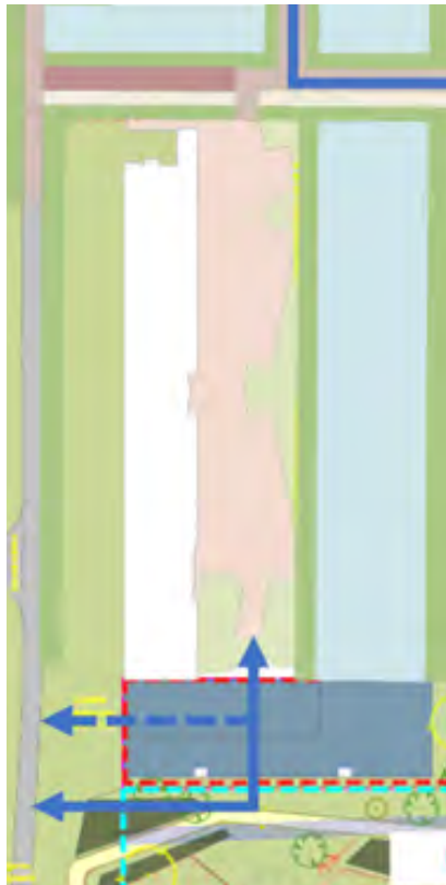
Figuur 12: Optie voor een zuidelijke ontsluiting van het parkeerterrein achter het Roche-gebouw. Dit is onderdeel van de optimale variant. Onderdeel van deze optie is om vrachtverkeer (expeditieverkeer, vuilniswagens en hulpdiensten) via de zuidelijke ontsluiting het parkeerterrein op te laten rijden en via de bestaande inrit aan de noordzijde het parkeerterrein weer af.
